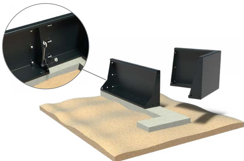
3. Percez des trous dans la base portante (il y a déjà des trous dans les murs de soutènement) Reliez ensuite les murs de soutènement au substrat au moyen de bouchons ou éventuellement d'un ancrage chimique.
